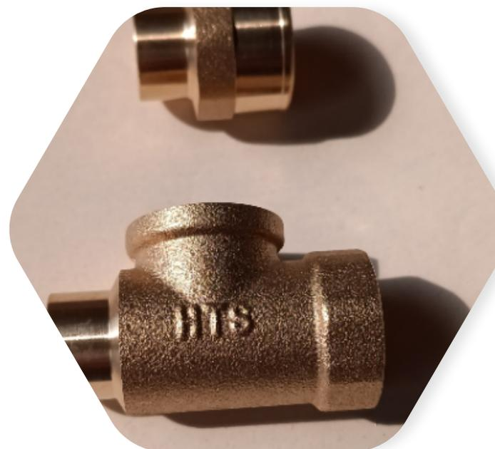
В теплообменниках конвекторов марки HTS используются оригинальные штуцера (HTS), которые изготавливаются из высококачественной латуни, предназначенной для пайки с медными трубами. Для удобства монтажа они имеют разную длину, что позволяет осуществлять подвод труб для прямого и углового соединения без дополнительных переходников.
